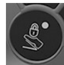
Бутон за заключване на педала за управление на скоростта
