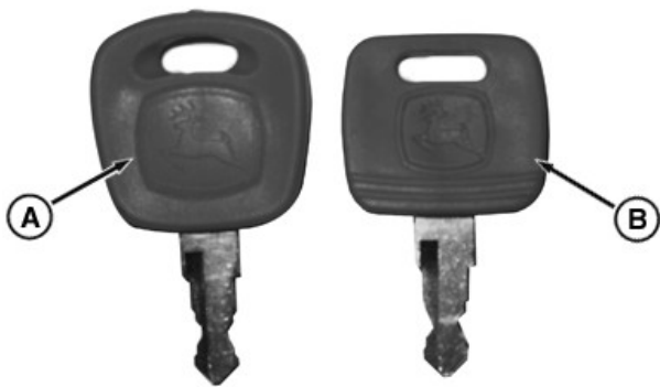
RXA0108294—UN—24JUN10 Ключ на имобилайзера сравнен със стандартния ключ на John Deere
