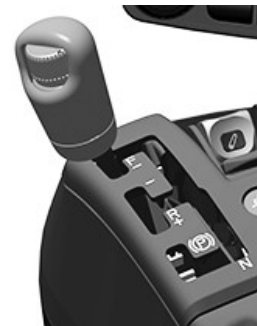
Десен лост за обръщане на посоката
