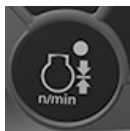
РХА0168437—UN—30MAY19 Бутон за ръчен режим на двигателя
