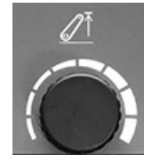
RXA0168029—UN—17MAY19 Selector de límite superior del enganche
