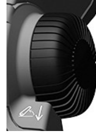
RXA0168025—UN—17MAY19 Cuadrante de ajuste de profundidad del elevador hidráulico
