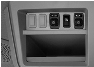
RXA0168462—UN—31MAY19 Ejemplo de controles del retrovisor eléctrico
