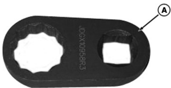
JDG10958 – удерживающий ключ для колесного балласта RXA0100328—UN—03FEB09
