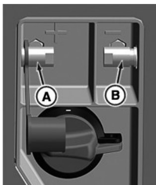
РХА0187645—UN—10AUG22 Выходы перемычки аккумуляторной батареи расположены рядом с лестницей трактора.
