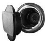
РХА0167981—UN—17MAY19 Розетка на 12 В для подключения аксессуаров
