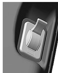
Рычаг аварийного тормоза RXA0169485—UN—02JUL19
