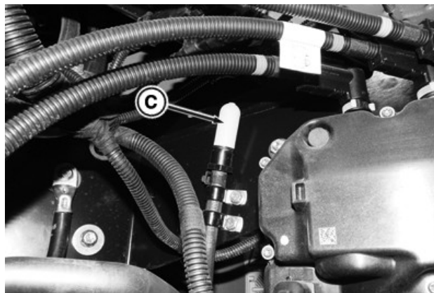
Фильтр вентиляции бака жидкости для очистки дизельных выхлопных газов (DEF) находится в аккумуляторном отсеке над дозатором жидкости DEF.
