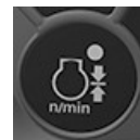
Кнопка ручного режима двигателя RXA0168437—UN—30MAY19
