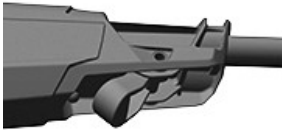
Ручне блокування телескопічного важеля
