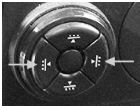
Блок керування подовжувача поперекової опори (Ultimate)
