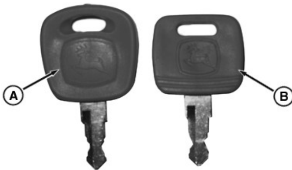
RXA0108294—UN—24JUN10 Ключ для іммобілайзера порівняно до стандартного ключа John Deere
