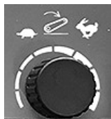
Ручка налаштування глибини зчіпки
