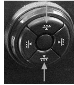
Блок керування висотою поперекової опори (Ultimate)
