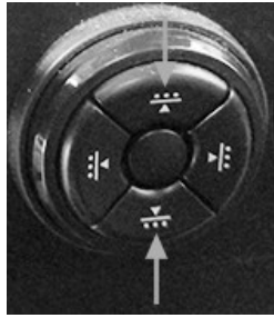
Блок керування висотою поперекової опори (Ultimate)
