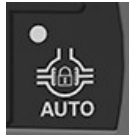
Кнопка автоматичного режиму механізму блокування диференціала
