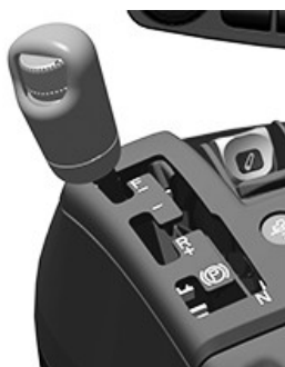
Приклад блока керування частотою обертання та зміщенням
