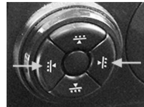
Блок керування подовжувача поперекової опори (Ultimate)
