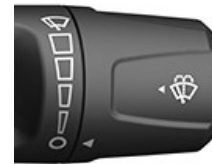
Частота обертання переднього склоочисника
