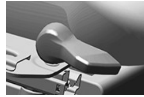
Блок керування блокуванням від повороту
