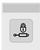
Селективные контрольные клапаны заблокированы RXA0180093—UN—09OCT20
