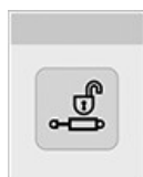
Селективные контрольные клапаны разблокированы RXA0180094—UN—09OCT20
