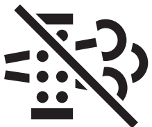
Témoin de désactivation du nettoyage automatique
