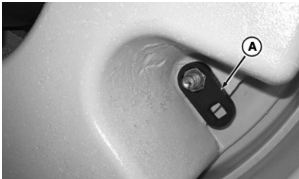
RXA0100330—UN—03FEB09 Masse de lestage de roue intérieure
