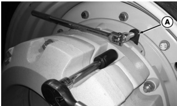
RXA0100329—UN—03FEB09 Masse de lestage de roue extérieure
