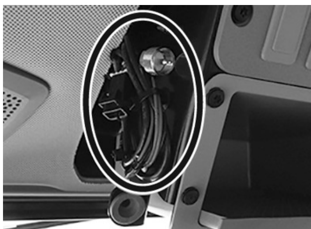
RXA0169831—UN—05AUG19 Antenne et câbles d'alimentation
