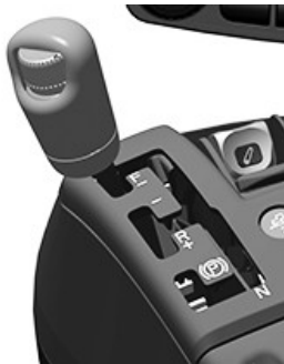
Esempio di comando velocità/cambio
