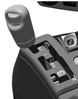
Десен лост за обръщане на посоката
