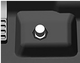
Подов превключвател за блокажа на диференциала
