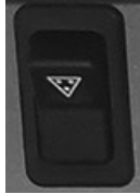
Ключ за светлините на ремаркетото
