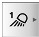
Предварителна настройка на работните светлини 1 RXA0168489—UN—31MAY19
