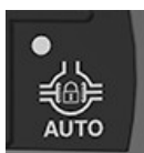
Бутон за автоматичен блокаж на диференциала
