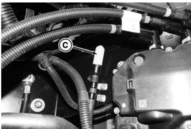
Вентилационният филтър на резервоара за DEF (C) е в отделението за акумулатора, над дозиращото устройство за DEF.
