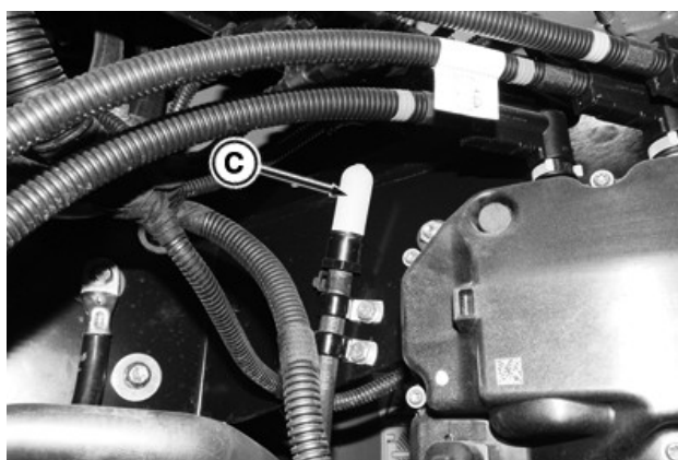
RXA0142031—UN—03JUN14 El filtro del orificio de ventilación del depósito de DEF (C) se encuentra en el compartimento de la batería, encima del unidad de dosificación de DEF.
