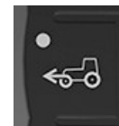
Pulsante trazione anteriore meccanica
