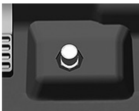
Interruttore a terra bloccaggio differenziale
