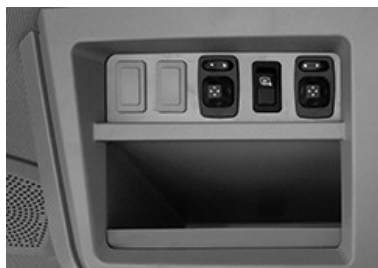
RXA0168462—UN—31MAY19 Esempio di comandi del retrovisore elettrico
