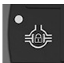
Pulsante bloccaggio del differenziale
