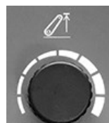
RXA0168029—UN—17MAY19 Manopola sollevatore limite superiore
