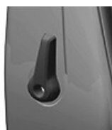
RXA0167342—UN—03APR19 Comando regolazione lombare - Selezione
