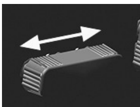
RXA0167328—UN—03APR19 Comando posizione longitudinale - Premium e Ultimate
