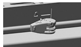
Comando di rigidità di guida
