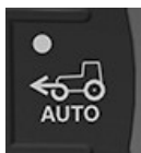
Pulsante trazione anteriore automatica (AUTO)
