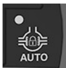
Pulsante bloccaggio automatico del differenziale (AUTO)
