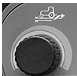
Manopola sollevatore sforzo/profondità
