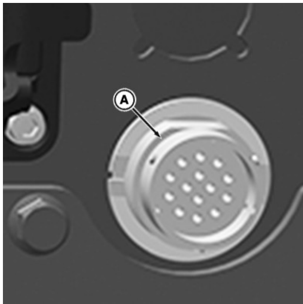
RXA0179346—UN—24AUG20 Az AutoLoad™ vezetékköteg csatlakozó kimenete az SCV tömb felett van
