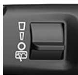
RXA0167459—UN—12APR19 Jobb oldali/hátsó ablaktörlő sebesség/mosó kar
