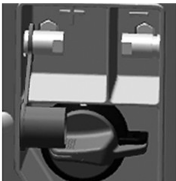
RXA0185275—UN—01SEP21 Az akkumulátor áthidaló akkumulátorsarkok a traktor lépcső közelében találhatóak.
