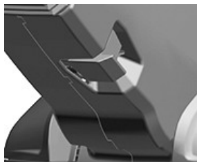
Levier d'arrêt d'inclinaison/de télescopage
