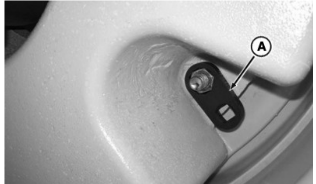
Masse de lestage de roue intérieure
