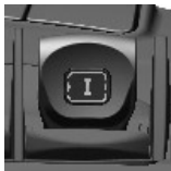
Levier du distributeur auxiliaire I
