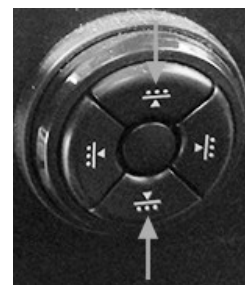
RXA0167331—UN—03APR19 Commande de hauteur lombaire - Ultimate
