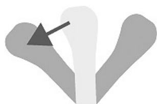
RXA0167696—UN—30APR19 Désenclencher la prise de force
