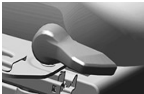
RXA0167322—UN—03APR19 Commande de verrouillage du pivotement
