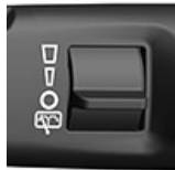
Levier de vitesse d'essuie-glace/lave-glace droit/arrière
