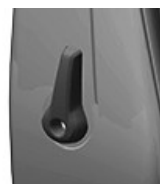
RXA0167342—UN—03APR19 Commande de réglage de l'appui lombaire - Select
