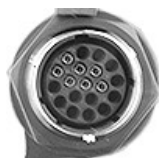
Connecteur de la console GreenStar™
