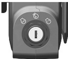
Contacteur de démarrage
