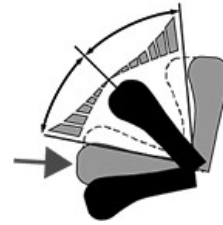
Cran d'arrêt de position de rétraction
