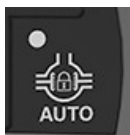
Bouton de blocage automatique du différentiel
