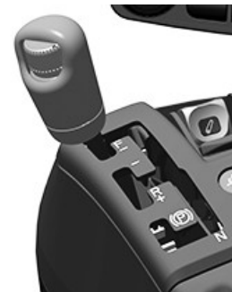
Levier d'inverseur sur console
