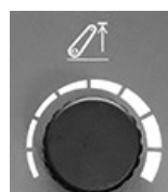
RXA0168029—UN—17MAY19 Molette de réglage de la limite supérieure du relevage
