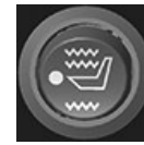
Commande d'intensité de la ventilation/du chauffage - Ultimate
