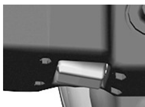
Commande de l'inclinaison de l'accoudoir
