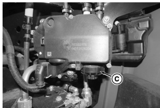
Filtar jedinice za doziranje DEF (C) nalazi se u odjeljku akumulatora, pri dnu jedinice za doziranje DEF.
