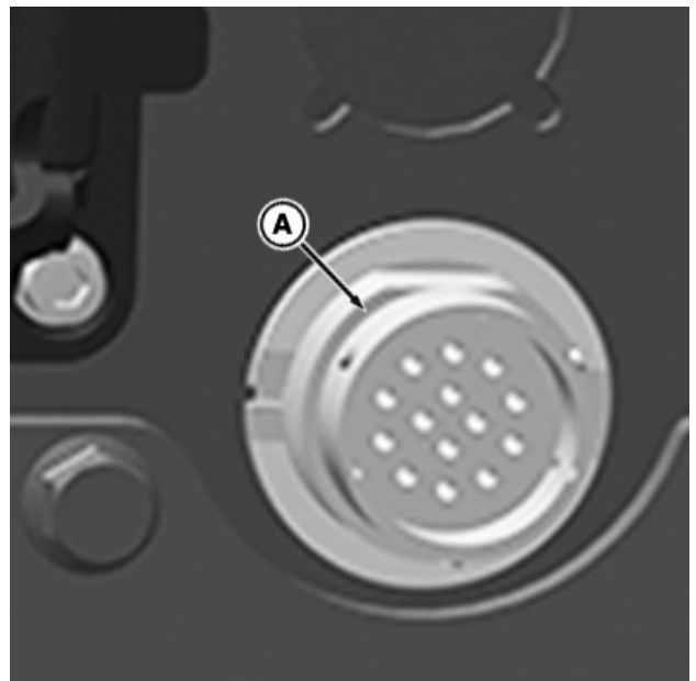
Utičnica priključka kablenskog snopa AutoLoad™ iznad je sklopa selektivnih regulacijskih ventila
