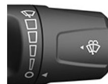
Velocidad del limpiaparabrisas delantero
