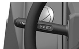
Palanca de luces
