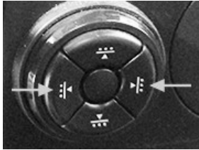
RXA0167333—UN—03APR19 Control de extensión lumbar - Ultimate
