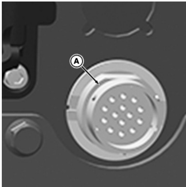
Розетка разъема жгута проводов AutoLoad находится выше блока селективных контрольных клапанов
