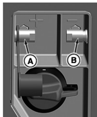
Выводы перемычки аккумуляторной батареи расположены рядом с лестницей трактора.
