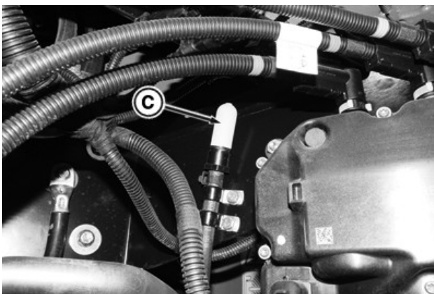
Филтерот за вентилација на резервоарот за DEF (C) се наоѓа во преградата на акумулаторот, над дозирачката единица за DEF.
