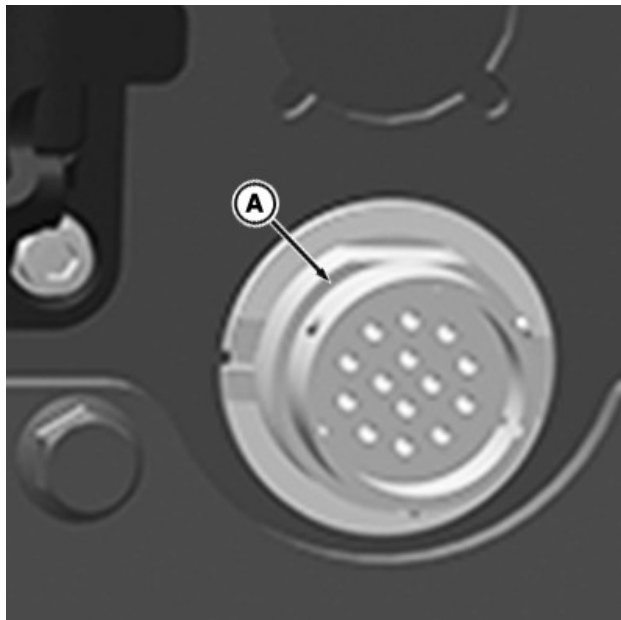
RXA0179346—UN—24AUG20 Zásuvka konektoru kabeláže AutoLoad je nad blokem SCV.
