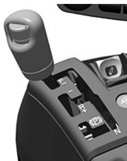
RXA0171324—UN—10OCT19 Przykład sterowania prędkością/zmianą biegów
