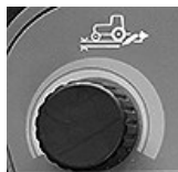
Drejegreb til træktøjets belastningsdybde
