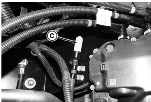
RXA0142031—UN—03JUN14 Вентилационният филтър на резервоара за DEF (C) е в отделението за акумулатора, над дозиращото устройство за DEF.
