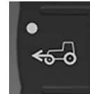
Pulsante trazione anteriore meccanica
