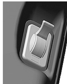
Leva del freno di emergenza
