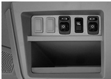
RXA0168462—UN—31MAY19 Esempio di comandi del retrovisore elettrico
