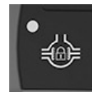
Pulsante bloccaggio del differenziale
