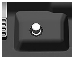
Interruttore a terra bloccaggio differenziale
