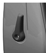
Comando regolazione lombare - Selezione
