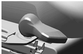
Comando di blocco rotazione
