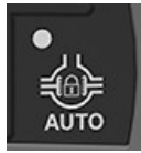
RXA0168428—UN—30MAY19 Pulsante bloccaggio automatico del differenziale (AUTO)
