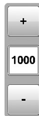
RXA0167699—UN—30APR19 Regolatore del regime della PTO posteriore
