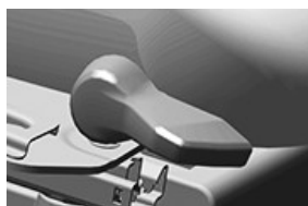
Comando di blocco rotazione
