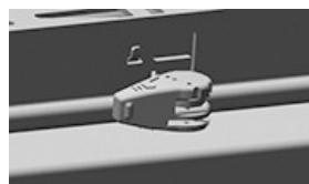
Comando di rigidità di guida
