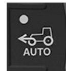
Pulsante trazione anteriore automatica (AUTO)
