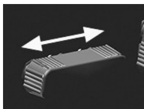
Comando posizione longitudinale - Premium e Ultimate
