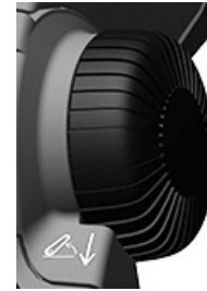
Круговой регулятор заглубления навесного рабочего оборудования
