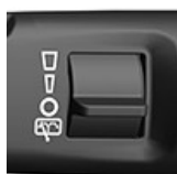
РХА0167459—UN—12APR19 Рычаг скорости правого/заднего стеклоочистителя/стеклоомывателя
