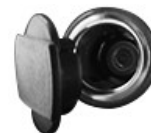
Разъем для подключения дополнительного оборудования, 12 В RXA0167981—UN—17MAY19
