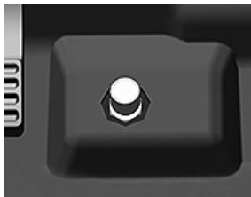
Напольный переключатель блокировки дифференциала
