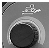
Регулятор глубины загрузки навески
