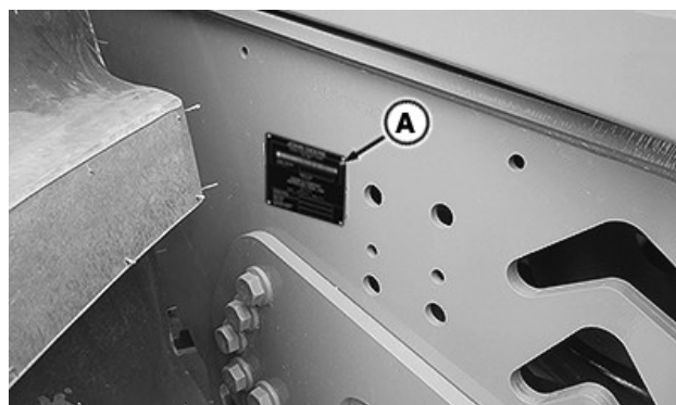
Табличка с номером PIN (A) находится на правой стороне рамы трактора
