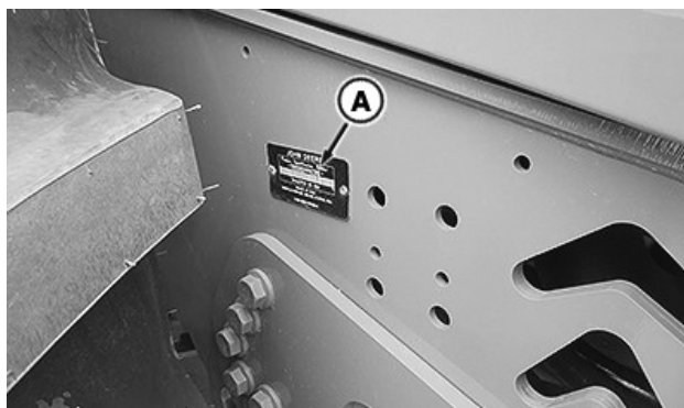
Табличка с номером PIN (A) находится на правой стороне рамы трактора
