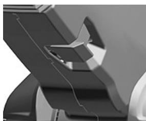
Стопорный рычаг наклона и вытягивания
