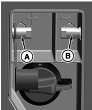
RXA0187645—UN—10AUG22 Аккумуляторлық батареяның жалғауыш клемма істікшелері трактор баспалдақтарының жанында орналасқан.
