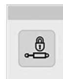
RXA0180093—UN—09OCT20 选择控制阀已锁定
