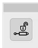
RXA0180094—UN—09OCT20 选择控制阀已解锁
