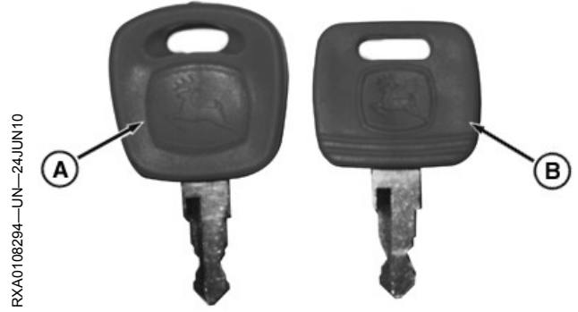
مقارنة مفتاح مانع الحركة مع مفتاح John Deere القياسي
