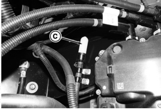
يوجد مرشح تنفيس خزان سائل عادم الديزل (C) في حجرة البطارية، فوق وحدة تحديد جرعة سائل عادم الديزل.
