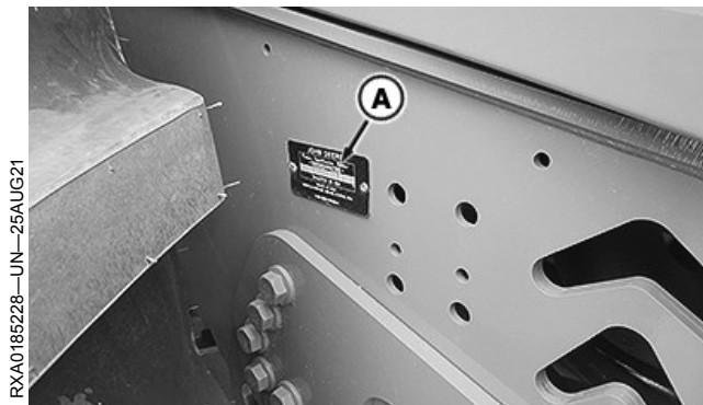
توجد لوحة رقم PIN (A) على الجانب الأيمن من إطار الجرار
