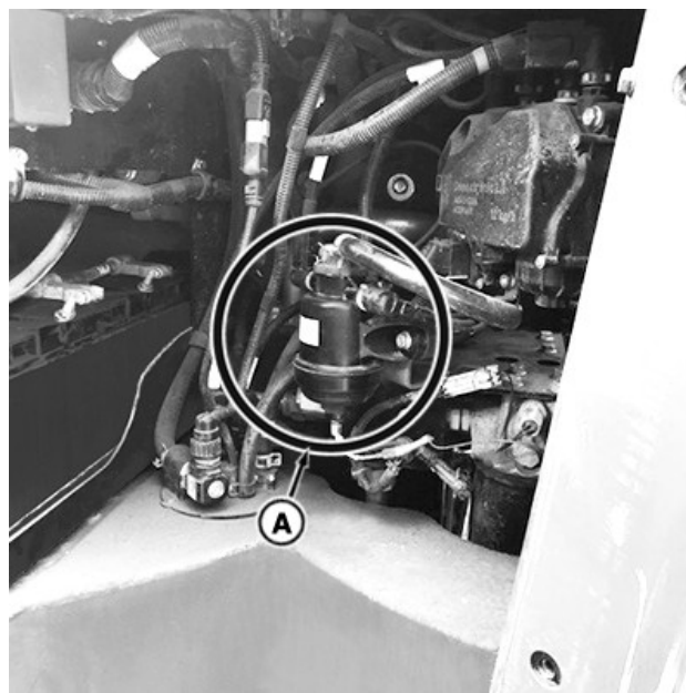
RXA0163952—UN—24JUL18 DEF фильтри (A) аккумулятор бўлмасининг ичида жойлашган.
