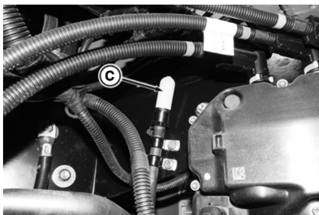
RXA0142031—UN—03JUN14 DEF баки вентиляция фильтри (C) батарея бўлмасида, DEF дозалаш блокнинг юқорисида жойлашган.
