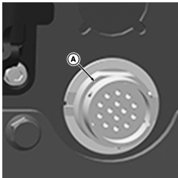
RXA0179346—UN—24AUG20 AutoLoad жгути коннектори розетки SCV тўпламидан юқорида бўлади
