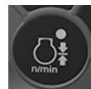
Моторды қолмен басқару режимінің түймешігі
