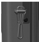
Апаттық жағдайда қолданылатын балға
