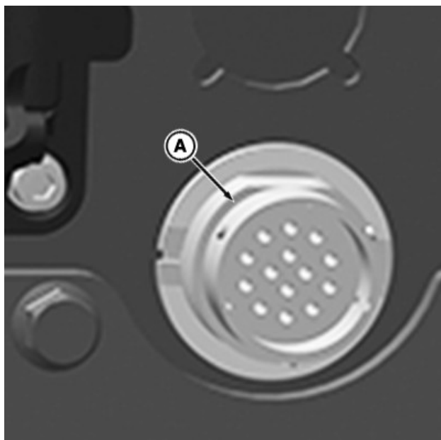
RXA0179346—UN—24AUG20 AutoLoad™ сымы коннекторының шығысы ТБК блогының үстінде орналасқан
