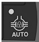
АВТОМАТТЫ дифференциал құлып түймешігі
