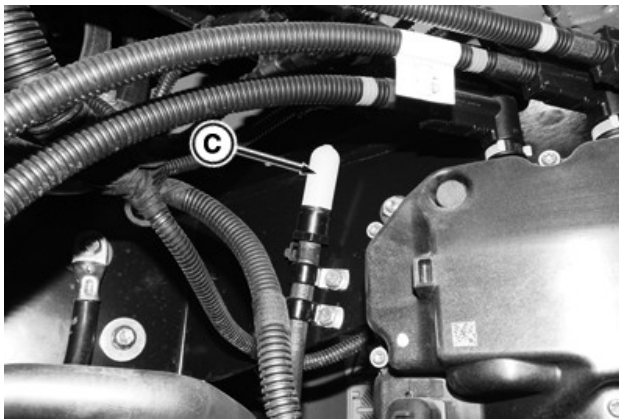
RXA0142031—UN—03JUN14 Der EntlüftungsfILTER (C) des DEF-Tanks befindet sich im Batteriefach über der DEF-Dosiereinheit.
