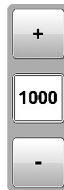
RXA0167699—UN—30APR19 Heckzapfwellen-Drehzahlbegrenzung einstellen
