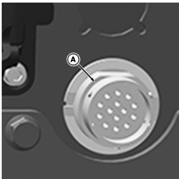
AutoLoad vadojuma savienotāja izeja atrodas virs SCV bloka
