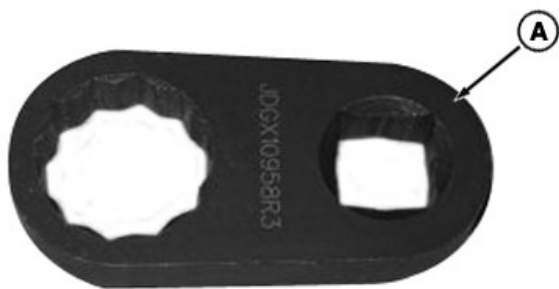
RXA0100328—UN—03FEB09 Llave de sujeción de contrapesos de ruedas JDG10958
