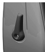
RXA0167342—UN—03APR19 Komanda za prilagođavanje potpore za kralježnicu – odabir
