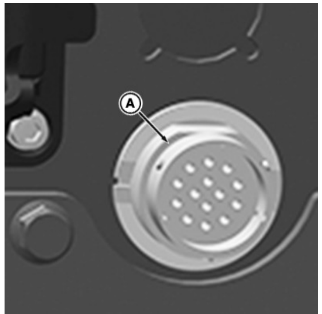
Utičnica priključka kabelskog snopa AutoLoad iznad je sklopa selektivnih regulacijskih ventila
