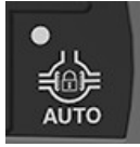
Tipka automatske blokade diferencijala
