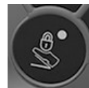
Tipka za blokadu papučice za kontrolu brzine
