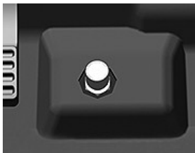
Podni prekidač blokade diferencijala
