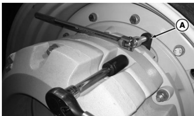
RXA0100329—UN—03FEB09 Vanjski uteg na kotaču
