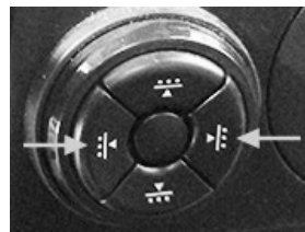
Komanda za dodatnu potporu za kralježnicu – Ultimate
