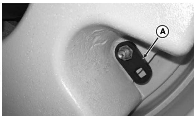
RXA0100330—UN—03FEB09 Unutarnji uteg na kotaču
