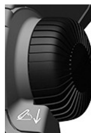
RXA0168025—UN—17MAY19 Sakabes darba dziļuma regulēšanas skala
