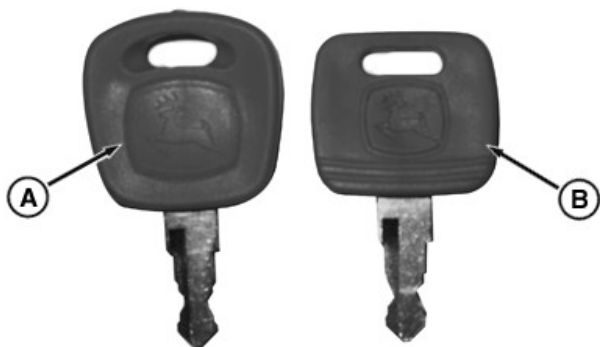
Ključ blokade u usporedbi sa standardnim John Deere ključem
