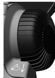
RXA0168025—UN—17MAY19 Brojčanik za namještanje dubine ovjesa
