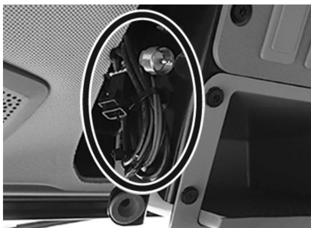
RXA0169831—UN—05AUG19 Antenn ja toitekaablid
