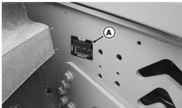
RXA0185268—UN—30AUG21 Toote identifitseerimisnumbri plaat (A) asub traktori raami paremal küljel
