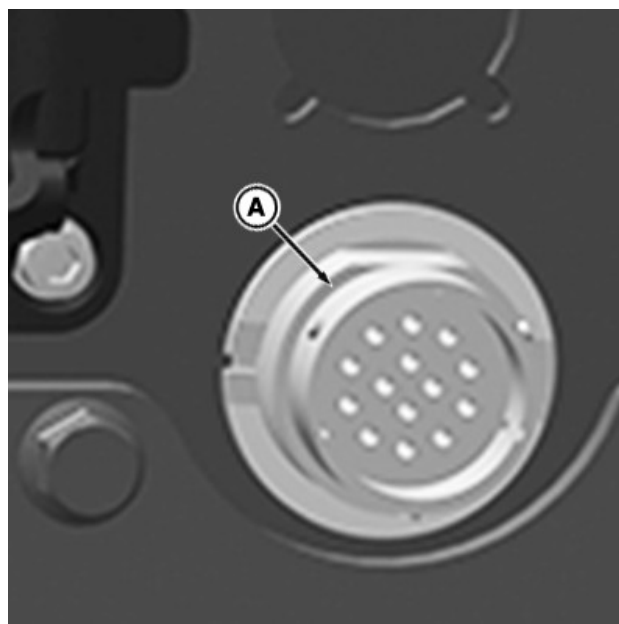
RXA0179346—UN—24AUG20 AutoLoadi juhtmekimbu konnektor asub hüdroväljavõtte plokki kohal
