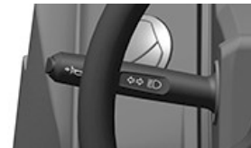
Hebel für Beleuchtung
