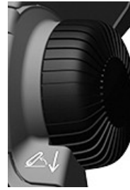
RXA0168025—UN—17MAY19 Drehknopf für Tiefeneinstellung des Krafthebers
