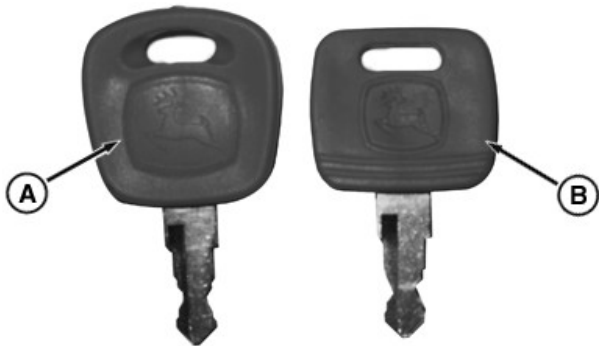
RXA0108294—UN—24JUN10 Schlüssel für Wegfahrsperr im Vergleich zum John Deere Standardschlüssel
