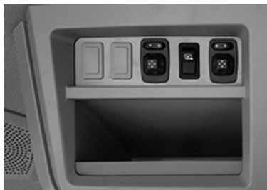
RXA0168462—UN—31MAY19 Beispiel für Bedienelemente für elektrische Spiegel
