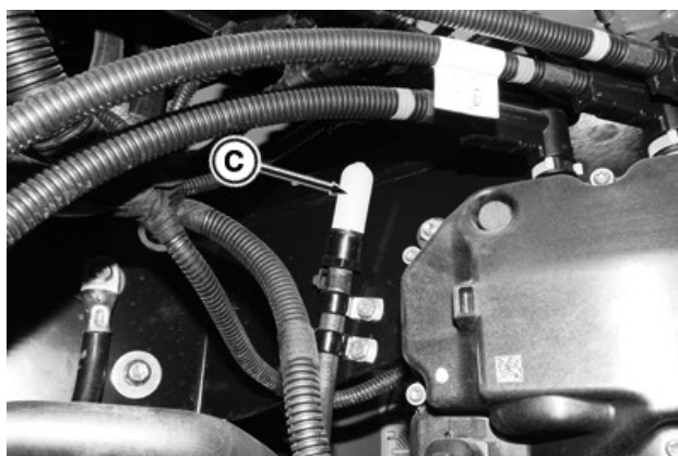
Der EntlüftungsfILTER (C) des DEF-Tanks befindet sich im Batteriefach über der DEF-Dosiereinheit.
