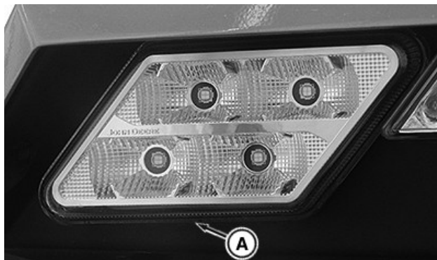
Kabinos stogo žibintas – parodytas LED žibinto pavyzdys
