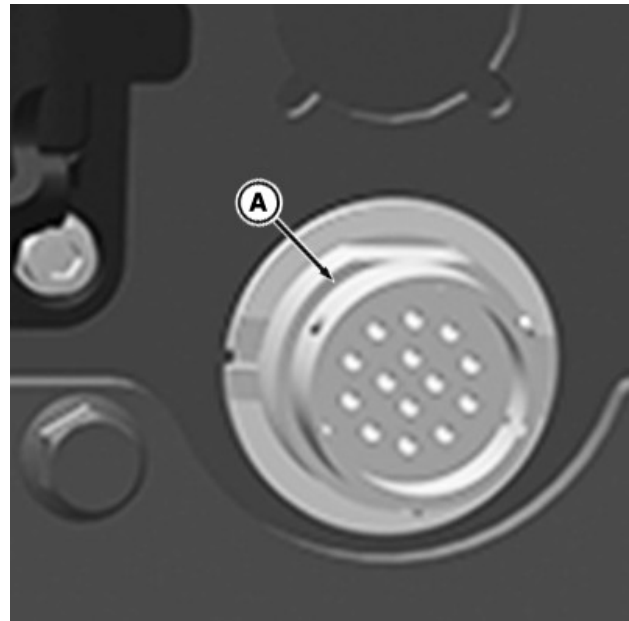
AutoLoad laidų pynės jungties lizdas yra virš SCV bloko
