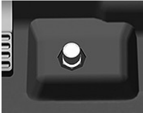
Diferencialo blokavimo mechanizmo jungiklis
