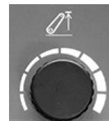
RXA0168029—UN—17MAY19 Prikabinimo įtaiso viršutinės ribos reguliavimo rankenėlė
