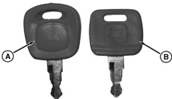
Llave del dispositivo antiarranque frente a llave estándar de John Deere
