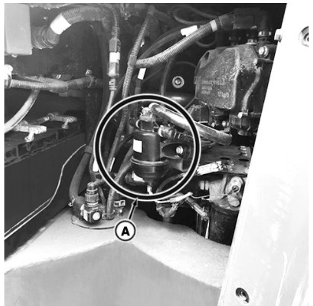
RXA0163952—UN—24JUL18 El filtro en línea de fluido de escape diésel (DEF) (A) está dentro del compartimento de la batería.
