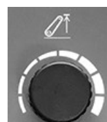
RXA0168029—UN—17MAY19 Otočný volič horného obmedzenia zadného závesu
