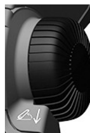
RXA0168025—UN—17MAY19 Otočný volič pre nastavenie hĺbky závesu
