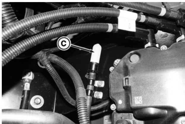
Le filtre (C) de l'orifice de dégazage du réservoir d'urée DEF se trouve dans le compartiment de batterie, au-dessus du système d'injection d'urée DEF.
