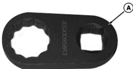
Clé de maintien pour masse de lestage de roue JDG10958
