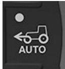
Automatiktaste für Frontantrieb
