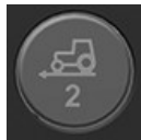
Taste für Einstellgeschwindigkeit 2
