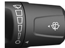
Geschwindigkeit für Frontscheibenwischer
