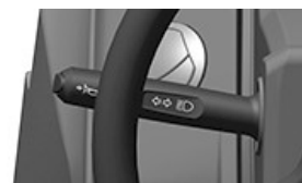
Hebel für Beleuchtung
