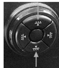
Bedienelement für Höhe der Lendenwirbelstütze – Ultimate
