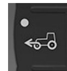
Taste für Frontantrieb
