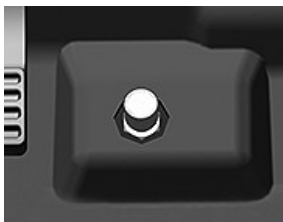
Fußschalter für Differenzialsperre
