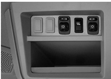
RXA0168462—UN—31MAY19 Beispiel für Bedienelemente für elektrische Spiegel
