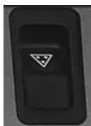
Schalter für Warnleuchten für Fahrten mit Anhänger
