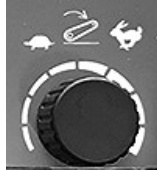
Drehknopf für Senkgeschwindigkeit des Krafthebers
