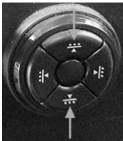
Bedienelement für Höhe der Lendenwirbelstütze – Ultimate
