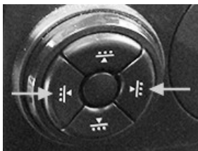
Bedienelement für Ausdehnung der Lendenwirbelstütze – Ultimate
