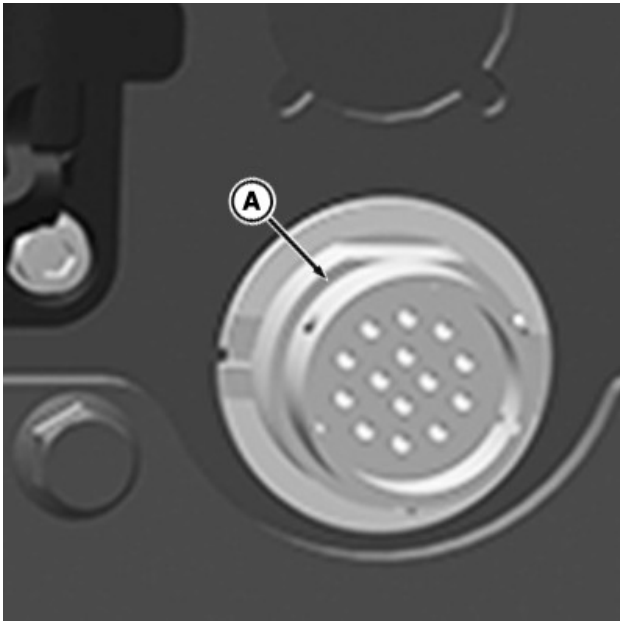
Der Steckerausgang des AutoLoad™-Kabelbaums befindet sich oberhalb des SCV-Blocks
