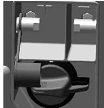
Die Pole des Batterie-Brückensteckers befinden sich in der Nähe der Traktorstufen.
