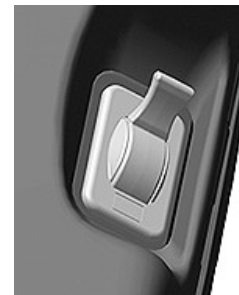
RXA0169485—UN—02JUL19 Hebel für Hilfsbremse
