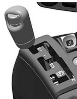
变速/换挡控制示例
