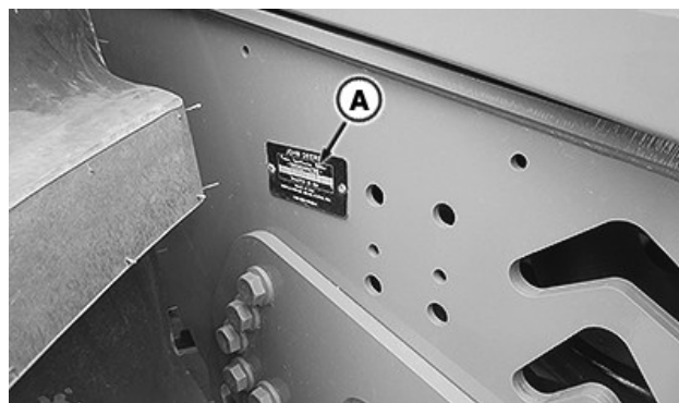
RXA0185228—UN—25AUG21 La placa del número de identificación de producto (A) se encuentra en el lado derecho del bastidor del tractor
