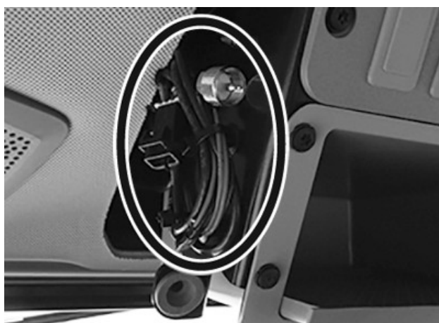
RXA0169831—UN—05AUG19 Antenne et câbles d'alimentation
