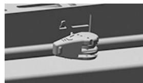
Commande de fermeté de la suspension
