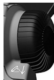
RXA0168025—UN—17MAY19 Molette de réglage de la profondeur du relevage
