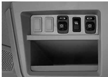
Exemple de commandes des rétroviseurs électriques
