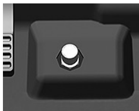
Contacteur au plancher de blocage du différentiel
