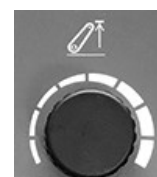
RXA0168029—UN—17MAY19 Molette de réglage de la limite supérieure du relevage
