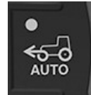
Bouton AUTOMATIQUE du pont avant mécanique
