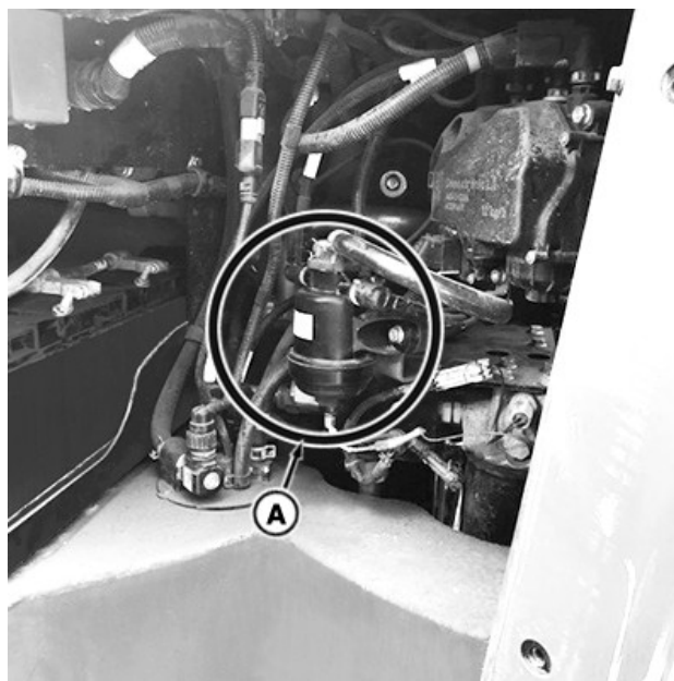
Прохідний фільтр сечовини (A) розташований з внутрішньої сторони відділення акумуляторної батареї.
