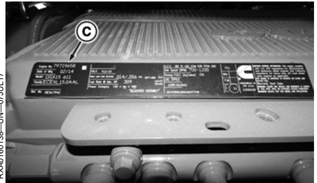
لوحة رقم تسلسل المحرك (C) موجودة على يسار غطاء صمام المحرك
