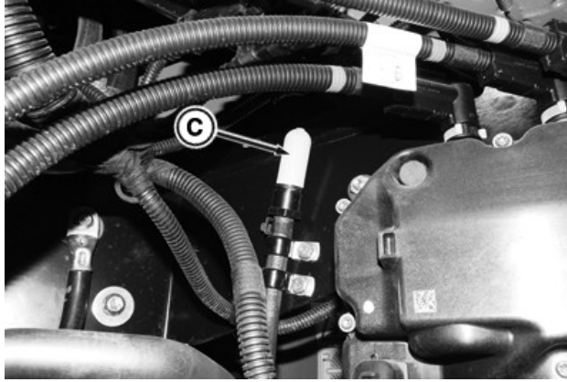
يوجد مرشح تنقيس خزان سائل عادم الديزل (C) في حجرة البطارية، فوق وحدة تحديد جرعة سائل عادم الديزل.
