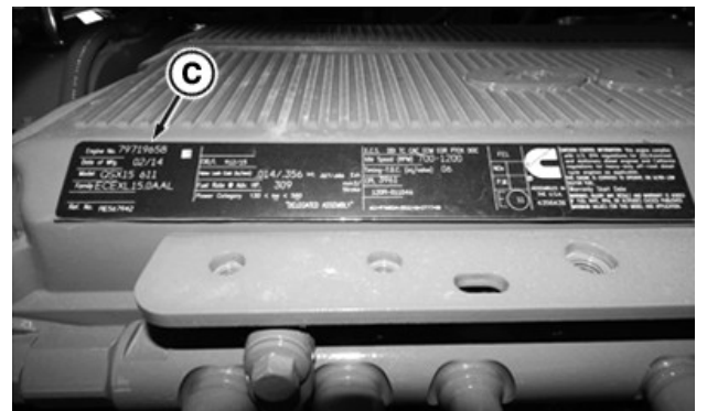
Табличка із заводським номером двигуна (C) розташована на двигуні зліва, на кришці клапана
