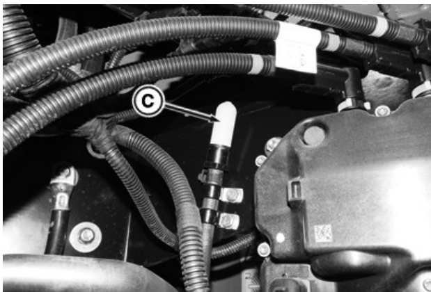
Вентиляційний фільтр бака для сечовини (DEF) (C) розташований у відсіку акумуляторної батареї над дозатором рідини для очищення дизельних вихлопних газів.
