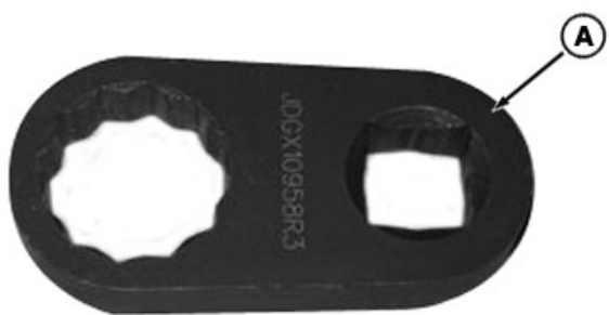
RXA0100328—UN—03FEB09 Clé de maintien pour masse de lestage de roue JDG10958
