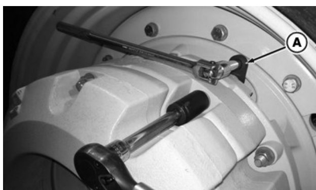
RXA0100329—UN—03FEB09 Masse de lestage de roue extérieure
