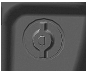
RXA0167320—UN—03APR19 Commande de hauteur d'accoudoir
