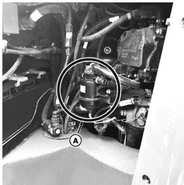
El filtro en línea de fluido de escape diésel (DEF) (A) está dentro del compartimento de la batería.
